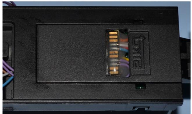
Trotzdem musste der Deckel im Bereich der oberen Pad-Reihe ausgenommen werden um einen sauberen Sitz zu erreichen. Am Schluss wurde noch das MX645 Label aufgeklebt.
