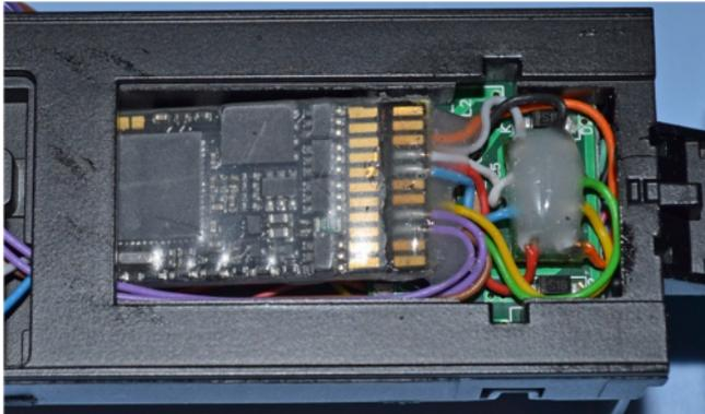
Die obere Pad-Reihe mit einer dünnen Schicht 2K-Klebstoff abdecken und die Schnittstellen-lötungen sichern.
